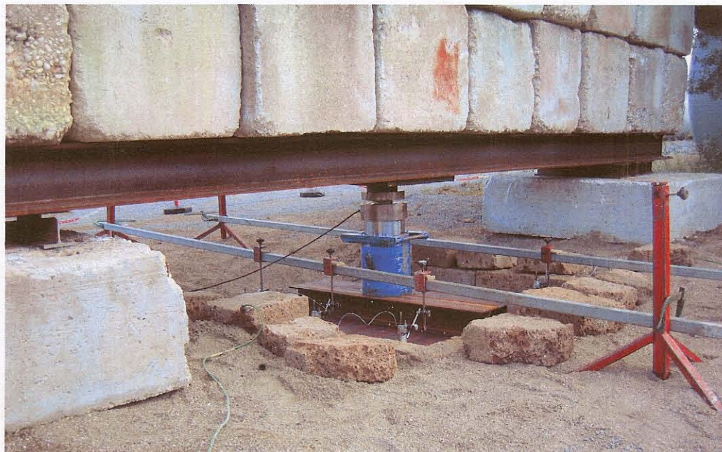
Particolare del martinetto sotto la trave di contrasto e disposizione degli strumenti di misura delle deformazioni.
